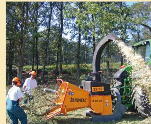
Déchiqueteuse à disques avec alimentation manuelle avec un rendement de 12 m<sup>3</sup>/h
