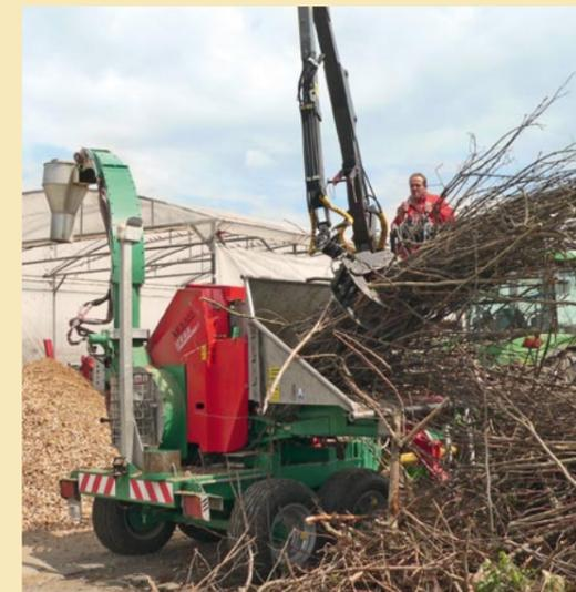
Déchiqueteuse à tambour à alimentation par grappin avec un rendement de 50 m<sup>3</sup>/h
