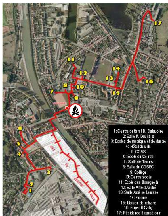
Figure 14 : Tracé du réseau de chaleur de la Ville d'Arques et emplacement des sous-stations (Source : site internet de la Ville d'Arques)
